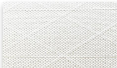
Un assemblage de composants plus ou moins chargés en **Dyneema®** permet de proposer une gamme complète en «One Side Ultra PE\*», pour les trois grammages légers (245 – 445) et «Two Side Ultra PE\*\*» pour les grammages lourds (495–645). Tous les laminés ZZ Ultra PE ont des inserts d'Ultra PE en chaîne à 0° et dans le biais à 70°. Le ZZ Ultra s'illustre par **sa souplesse et sa légèreté** qui facilite les manœuvres et diminue le vieillissement à l'usage.
